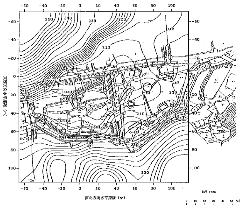
図4.1.3-4 測線図に重ねた基盤構造コンター図
