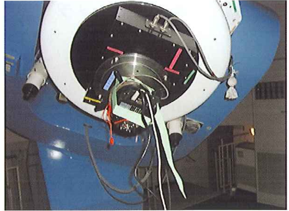
写真3 望遠鏡のカセグレン焦点に取り付けられた冷却 CCD カメラ。
