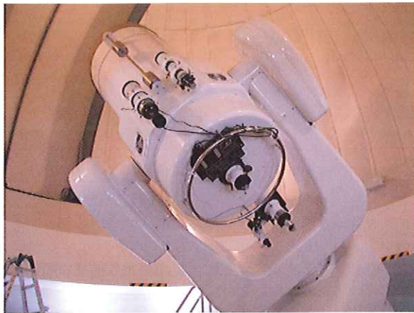
写真1 三瓶自然館60cm反射望遠鏡 (カセグレン式, F10, 西村製作所)
