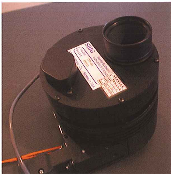
写真2 冷却CCDカメラ (ST10-XME, SBIG製)
