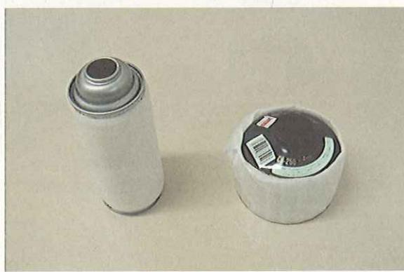
図1-1 スプレー缶、ガスボンベなどの底をレンズの型に利用する。
