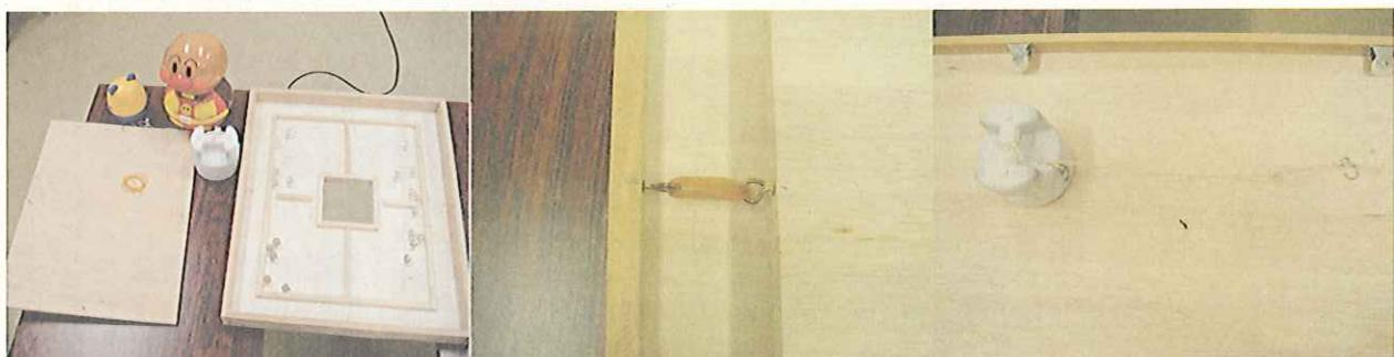
図3-1 左：振動板の材料一覧。振動支持板は中央に振り子を吊す穴、長辺サイドにキャスター、板面にビーベーを敷く。
