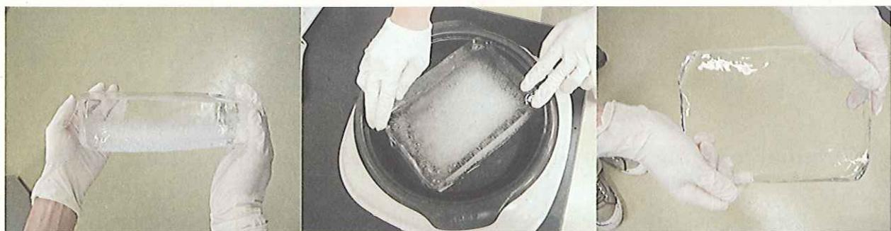
図1-2 冷凍庫で発砲スチロール内で凍らせた氷は、上が透明、下は不透明となる。
