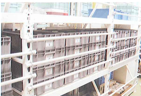
写真11 落下防止対策を施した収蔵庫の状態
