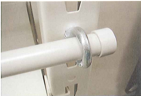
写真6 パイプを金具に通してキャップを付けた状態
