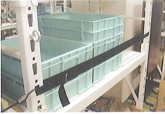
写真2 バンドを取り付けた状態
