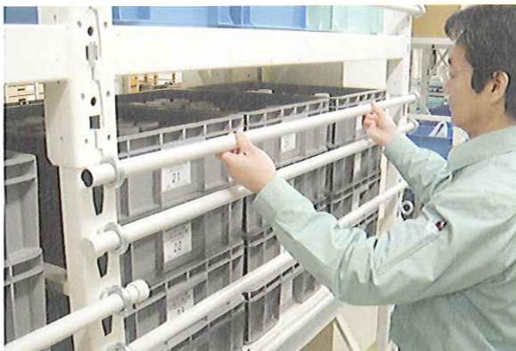
写真8 パイプを隣の空いた金具に通す
