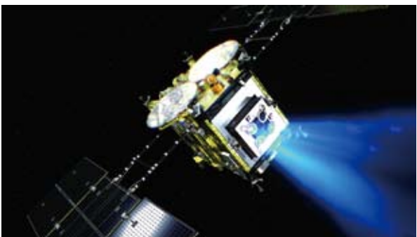
イオンエンジンを作動させて進むイメージ図(提供 JAXA)
